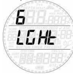
Smart ima pozadinsko svjetlo koje se može uključiti u slučaju slabog ambijentalnog svjetla. Aktivira se pritiskom i držanjem donje tipke. Tijekom zarona, svjetlo će biti upaljeno onoliko dugo kako ga podesite (između 1 i 10 sekundi).
