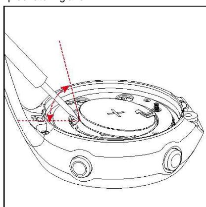
f) Zamjenite bateriju novom iz kita. Baterija mora kliknuti. Pripazite da poštujete pol baterije: "+" mora biti okrenut prema vani.
