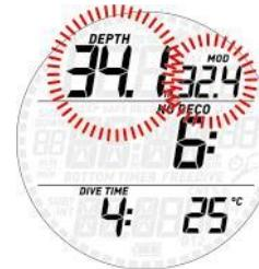
Alarm ostaje upaljen dok ronilac ne izroni dovoljno da se ppO<sub>2</sub> vrati unutar postavljene granice.
