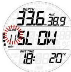
Ako brzina izrona premaši 12m/min na dubini ispod 12m, pojavljuje se simbol **SL OW DO WN!** i oznaka brzine trepće. Ako se brzina preko 12m/min zadrži pri dvjema trećinama dubine na kojoj se prvi put alarm pokrenuo, Smart to smatra kršenjem pravila zaronu, te će na zaslonu biti postojani simbol **DO WN!**
