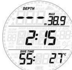
Nakon povratka na površinu Smart prelazi u tzv. **površinski** način (surface mode). Ovaj način omogućava vam da nastavite s ronjenjem nakon kratkog perioda orientacije. Na zaslonu se prikazuje odbrojavanje 3 minute.
