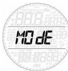
Na ovaj način možete definirati vrstu plina koju ćete udisati tijekom zarona (zrak obogaćeni zrak nitrox, uključujući i više plinova). Možete postaviti Smart na bottom timer, u tom slučaju Smart će pokazivati samo vrijeme, dubinu i temperaturu: neće vršiti obračune dekomprezije, niti upozorenja ili alarne. Smart možete postaviti i na freediving način (ronjenje na dah), što je zapravo bottom timer s posebnim funkcijama namijenjen roniocima na dah.
