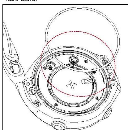
h) Postavite poklopac na kućište i pritisnite jednoliko. Pripazite da na području gdje su vijci poklopac dodiruje kućište sata.
