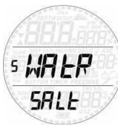
Možete postaviti računalo na **FRESH** (slatku) ili **SALT** (slano) vodu, ovisno o planiranom mjestu ronjenja. Postavljanjem pogrešnog tipa vode dolazi do pogreške u mjerenu dubine od cca 3% (tj. na dubini od 30 m, računalo postavljeno na slatku vodu pokazat će 29 m u slatkoj vodi, dok će računalo postavljeno na slatku vodu pokazati 31 m u slanoj vodi). Ovo ne utječe na samo ispravno funkcioniranje uređaja budući da računalo provodi sve izračune isključivo na temelju mjerjenja tlaka.
