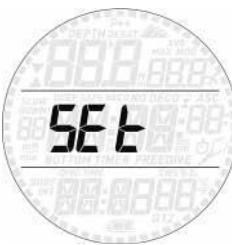
Smart-ov **SEt** izbornik omogućava promjenu postavki. Unutar ovog izbornika, pritisnite bilo koju tipku kako biste klizali između 2 podizbornika: **SEt dIVE**, gdje možete postaviti ronilačke parametre, i **SEt tIME**, gdje možete postaviti parametre vremena i datuma.
