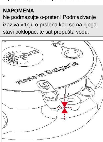
i) Držite poklopac pritisnut na kućištu dok ručno zatežete dva vijka. Ne koristite prekomjeru silu pri zatezanju. Idealni okretni moment iznosi 12 N cm
