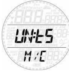
Možete odabrati između metričkih (dubina u metrima, temperatura u °C) i imperialnih jedinica (dubina u stopama, temperatura u °F).
