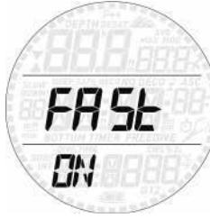
Brzi (nekontrolirani) izron definiran je kao onaj tijekom kojeg je brzina od 12 m/min ili viša zadržana tijekom više od 2/3 izrona. Ovo se primjenjuje samo na zarone dublje od 12m. U ovom slučaju, zbog potencijalnog stvaranja štetnih mješurića, Smart se zaključava na 24 h kako bi Vas odvratio od ideje ponovnog zarona. U ovom izborniku
